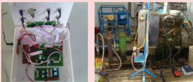
Bộ điều khiển sau khi chế tạo (trái) và hình ảnh bố trí thực tế thử nghiệm trên động cơ Yanmar 4CH tại Bộ môn Động Lực (phải)
